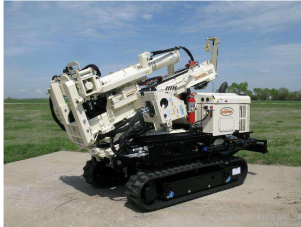
图3-1 7822DT型Geoprobe钻机
