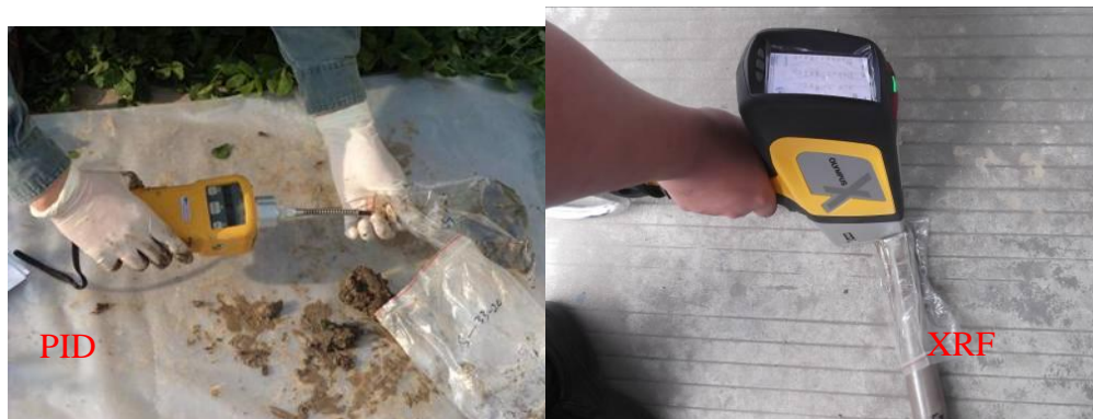
图3-2现场PID 与XRF检测
