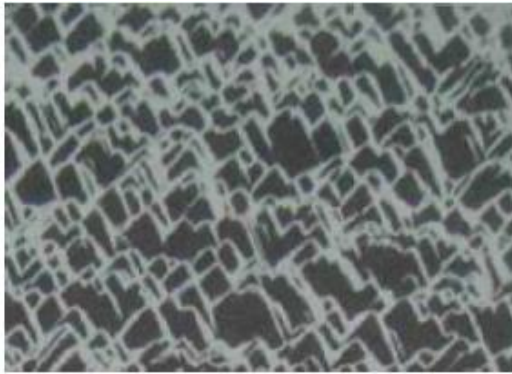
图 4-4 硅片表面绒面结构的扫描电镜图
