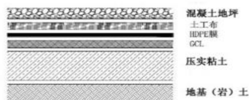
图 4-3 设计 HDPE 膜单层防渗结构示意图
